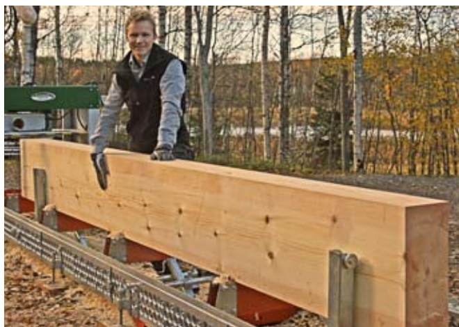
Resultatet: en 4 meter lång rikt- och planhyvlad balk på 20x50 cm. Imponerande! (Maxmättet som kan hyvlas eller profileras är över 60x60cm).
