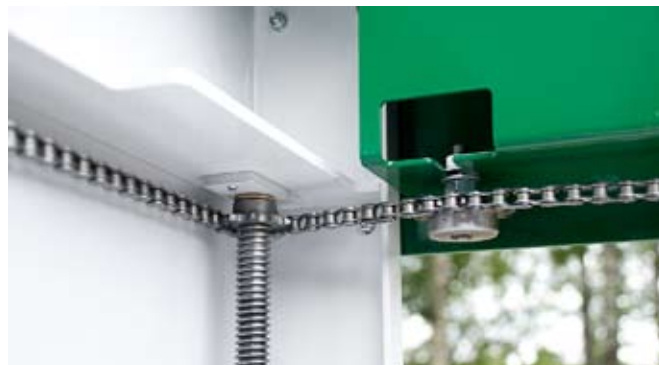
Kedjetransmissionen skall gå lätt! På bilden syns även kedjespännaren.
