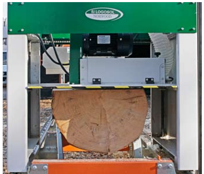
Hyvling i två steg. Här tillverkas en ovanligt stabil och planhyvlad ljugarbänk av en 55 cm grov stock.
