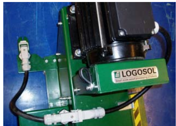
Timmerfräsens kablage med en extra kontakt som säkerhetsbrytare över locket.
